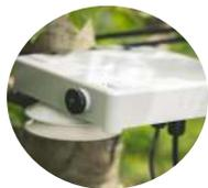
**Estación climática** con mediciones de temperatura y humedad cada treinta minutos diariamente
